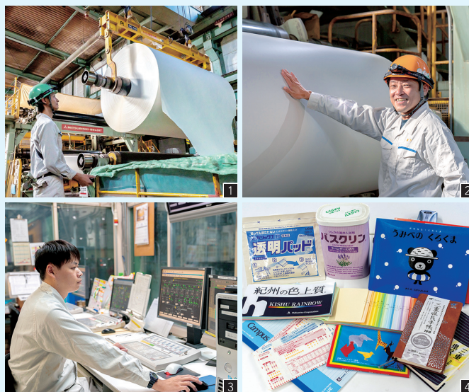
①紙の巨大なロールを15tクレーンで運搬 ②紙の厚みや光沢を触って品質を厳しくチェック ③全工程が正常に動作しているかを常に監視 ④おなじみの製品を多数製造
